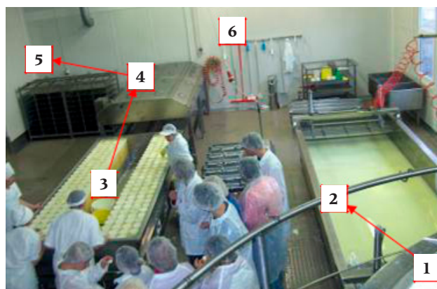
Joonis 37. Väike juustutööstus kõvade juustude tootmiseks: 1 – juustukatel, 2 – eelpressimis-vann, 3 – juustu-vormimise laud, 4 – tunnelpress, 5 – juustude konteiner, 6 – hügieeni tagamise vahendid.
