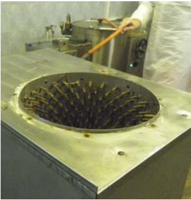
Foto 14. Väikeettevõttele sobiv sulgede eraldamise seade (tsentrifuugi põhi ja küljed on varustatud kummist sõrmedega).
