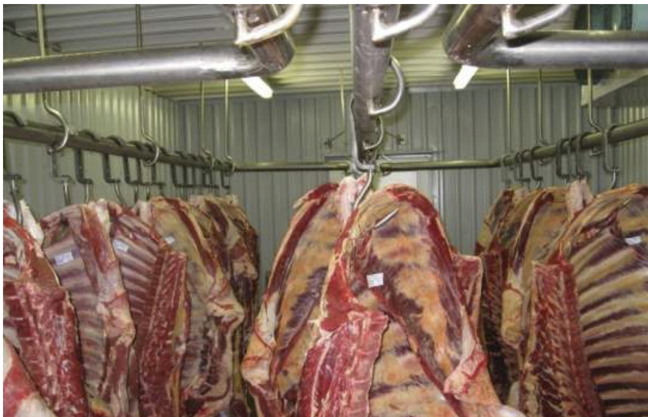
Foto 28. Veise veerandrümpade jahutamine.
